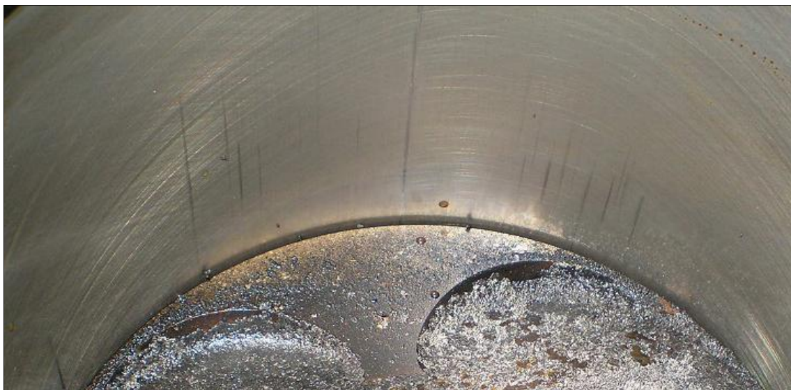
Und so sieht das aus, wenn er durchgekommen ist. (Am oberen Rand des Kolbens eine leichte Überwaschung. Die Kolbenoberfläche deutet darauf hin, daß der Motor zu heiß gelaufen ist)
